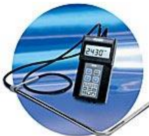
Mynd 9: Dæmigerður micromanometer tengdur við Pitot-rör
