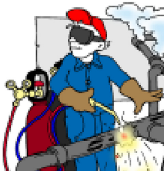
Notið suðugleraugu við logsuðu og logskurð.
