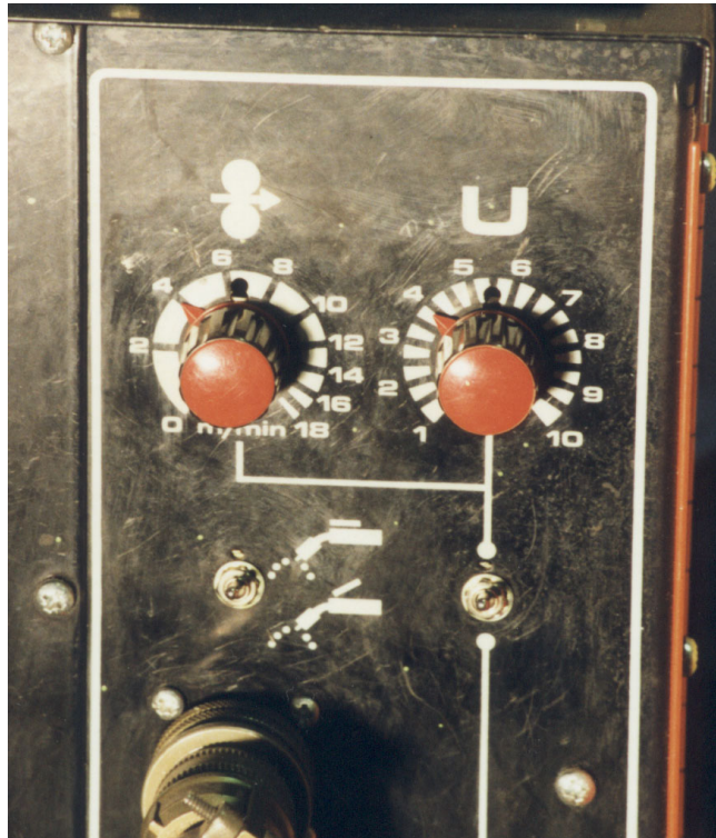
Þráðmötun og suðustraumur eru stillt með sama hnappi. Spennan er stillt með öðrum hnappi.
