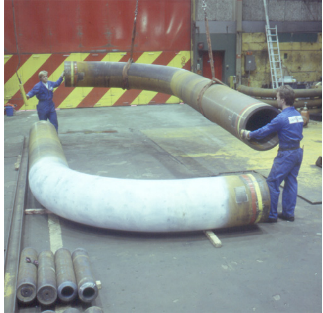
Spanbeygð rör úr 15Mo3 efni, stærð Ø 610 x 36
