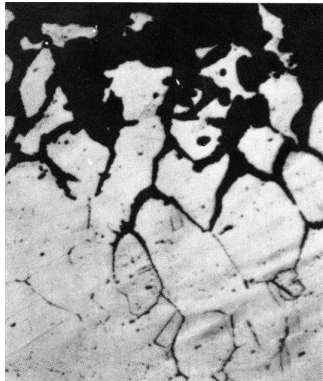
Krómkarbítar, ásamt samdráttarspennum geta valdið innbyrðis spennusprungumyndunum á milli kristalla.
