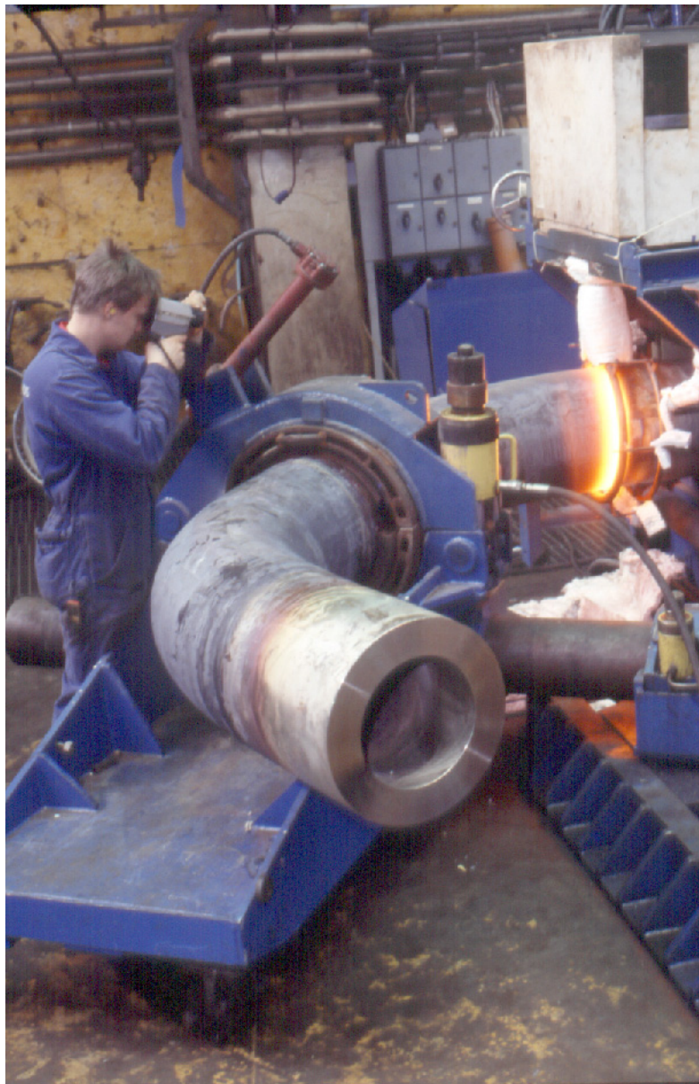
Spanbeyging Super Duplex-röra. Stærð Ø 426 x 82.
