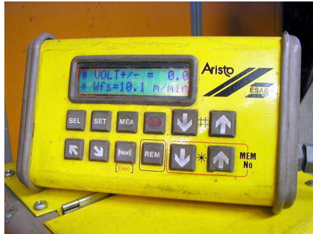
S.k. fjölnotavélum er stýrt með örtölvu. Þetta auðveldar að samhæfa allar þær stillibreytur sem vinna eiga saman. Á myndinni er ESAB Aristo 500.
