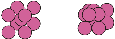
Á uppbyggingu kristalsins sést að ferrítið (t.v.) hefur minna pláss fyrir kolefni en austenítið (t.h.).
