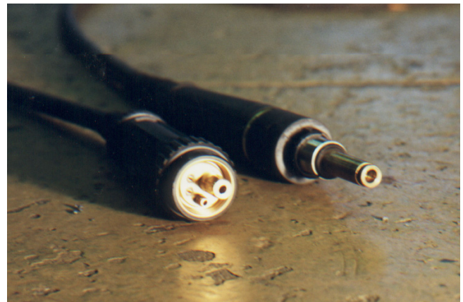
Tenging suðuleiðslunnar við straumgjafann getur verið s.k. Evrópugerð eða hin sérstaka ESAB gerð.
