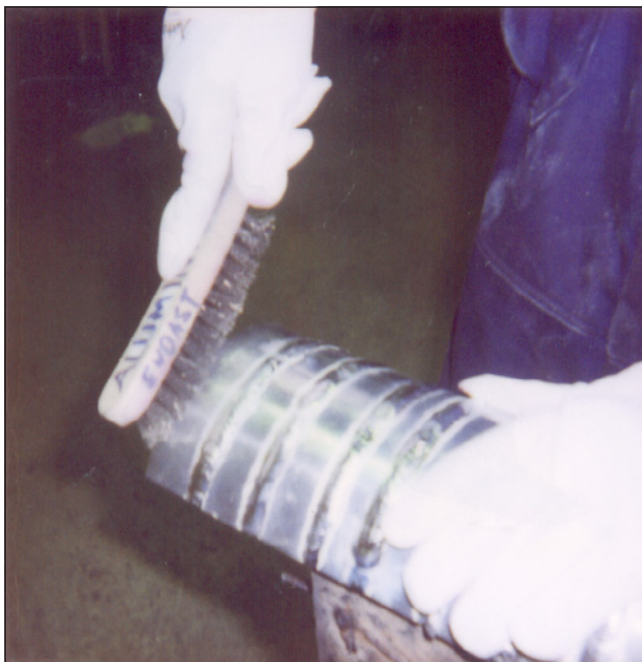
Hreinsun með vírbursta er áhrifarík aðferð. Munið að nota aðeins ryðfría bursta á ál.
