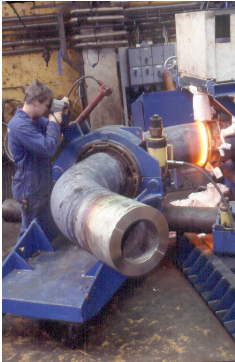
Spanbeyging Super Duplex-röra. Stærð Ø 426 x 82.
