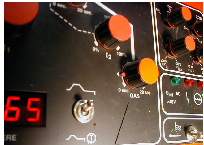
Stilling eftirflæðis hlífðargass á TIG-suðuvél.
