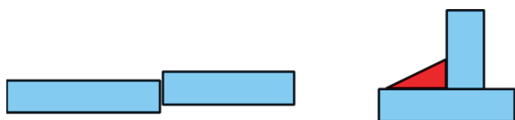
Misbrýning og röng hlutföll í suðulögun eru tvö dæmi um formgalla.
