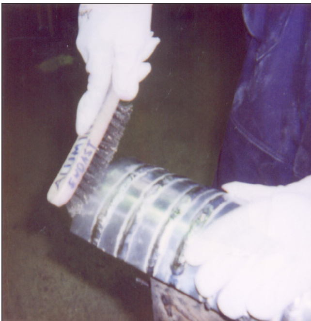
Hreinsun með vírbursta er áhrifarík aðferð. Munið að nota aðeins ryðfria bursta á ál.
